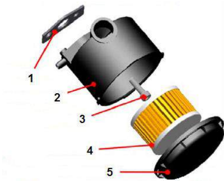
Рисунок 8 - Входной воздушный фильтр.
