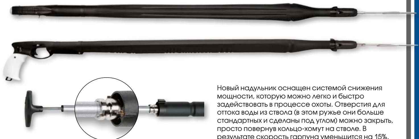
Новый надульник оснащен системой снижения мощности, которую можно легко и быстро задействовать в процессе охоты. Отверстия для оттока воды из ствола (в этом ружье они больше стандартных и сделаны под углом) можно закрыть, просто повернув кольцо-хомут на стволе. В результате скорость гарпуна уменьшится на 15%.
