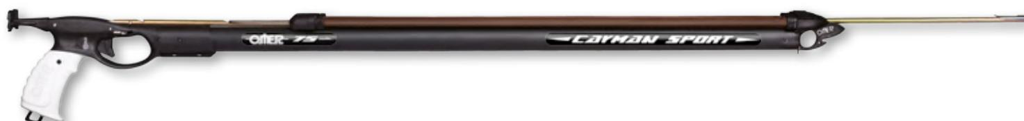
Классический подводный арбалет OMER со стволом анодированного алюминия, 6,5-мм гарпуном из стали PR80, стандартным зацепом и тягами Top Energy 16.5.
